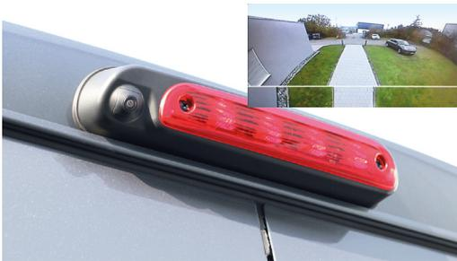
**DBC 1140182 DV Dual View:** Rückfahrkamera integriert in speziell entwickelter Bremslichtkonsole zur Montage an Fiat Ducato, Peugeot Boxer und Citroen Jumper. Die DualView Technologie ermöglicht es, auf einem Bildschirm gleichzeitig die Sicht nach unten und nach hinten darzustellen. Die Kamera liefert ein zweigeteiltes Bild mit einer TOP-DOWN Ansicht des Fahrzeughecks zum Rangieren und einer Ansicht des rückwärtigen Verkehrs.
