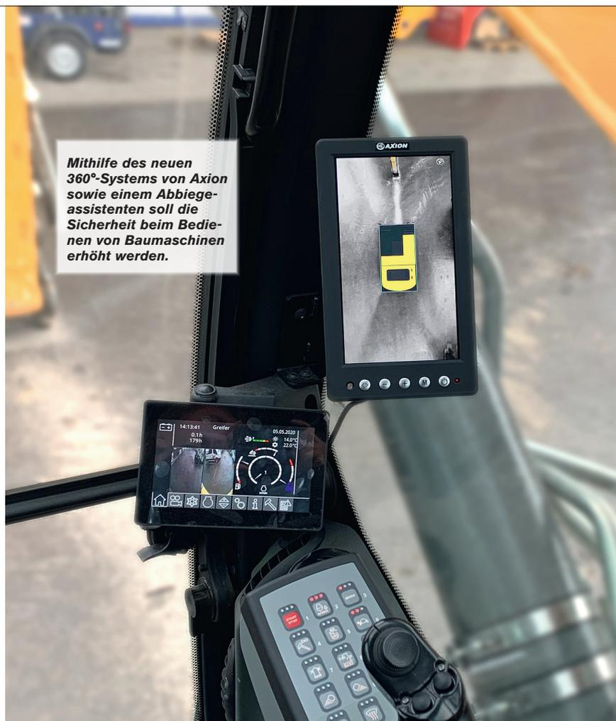
Mithilfe des neuen 360°-Systems von Axion sowie einem Abbiegeassistenten soll die Sicherheit beim Bedienen von Baumaschinen erhöht werden.
